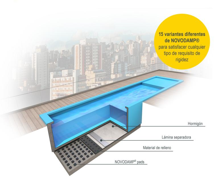
NOVODAMP® es líder en soluciones de pads, ya que no tiene rival con 15 opciones diferentes, cortes de precisión y cortes de 5 mm. Cada tipo de material es un testimonio de nuestro compromiso con la innovación. Las características de NOVODAMP® no cambian con el tiempo, la temperatura, las cargas estáticas o transitorias.
